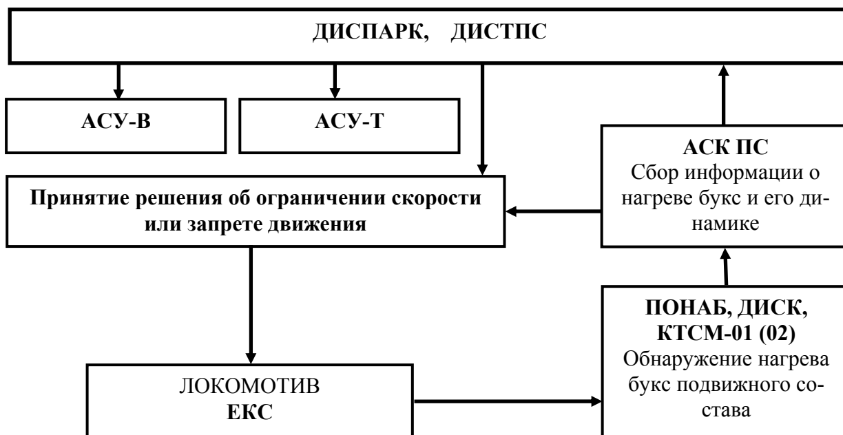
Рис. 8.5. Контроль за нагревом букс в МАСУ БД:
